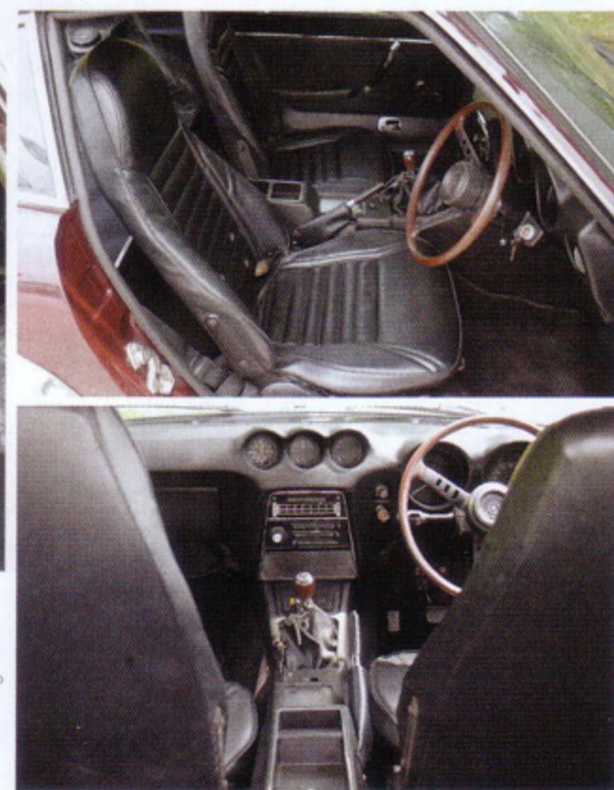
室内も良くこれだけの状態が保たれていたかのよう、状態は○。細かいところを見ていくと、ダッシュボード、センターコンソールはS30と同様、昭和46年3月生産からのものと同様、シートもそうだ。ちなみにちらっと見えるワイパーアーム、HS30系は黒塗装が正解だ。トランクルームもキレイな状態のまま保たれていた。この年式のゲートダンパーは写真の1本が正解
